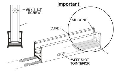
BE SURE THE SHOWER IS PROPERLY SILICONED BEFORE INSTALLING THE DOOR
